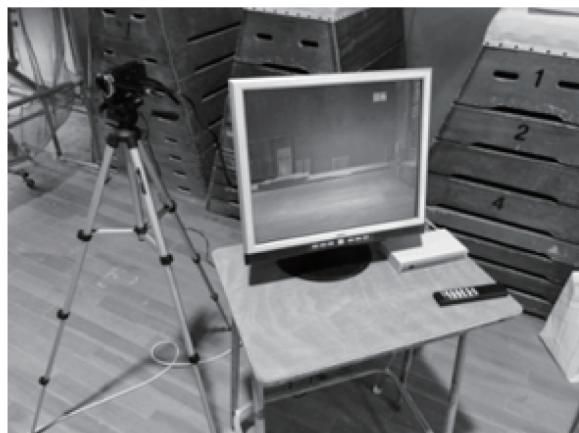
図1 映像遅延装置の使用場面
