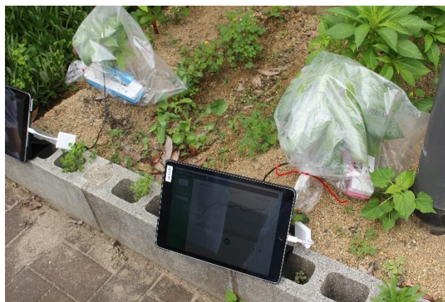
図2 アカダコセンサーを利用して袋内の湿度を測定している様子
